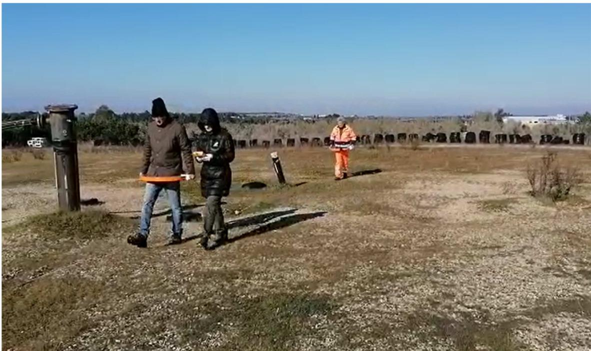
Configurazione Horizontal Magnetic Dipole (HMD) con dipoli magnetici distanziati di 10 metri.
