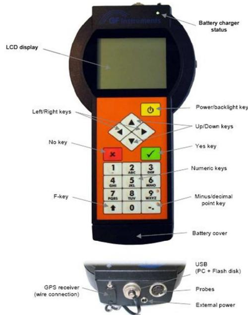
Fig. 3 – Unità di controllo integrata CMD/C.
