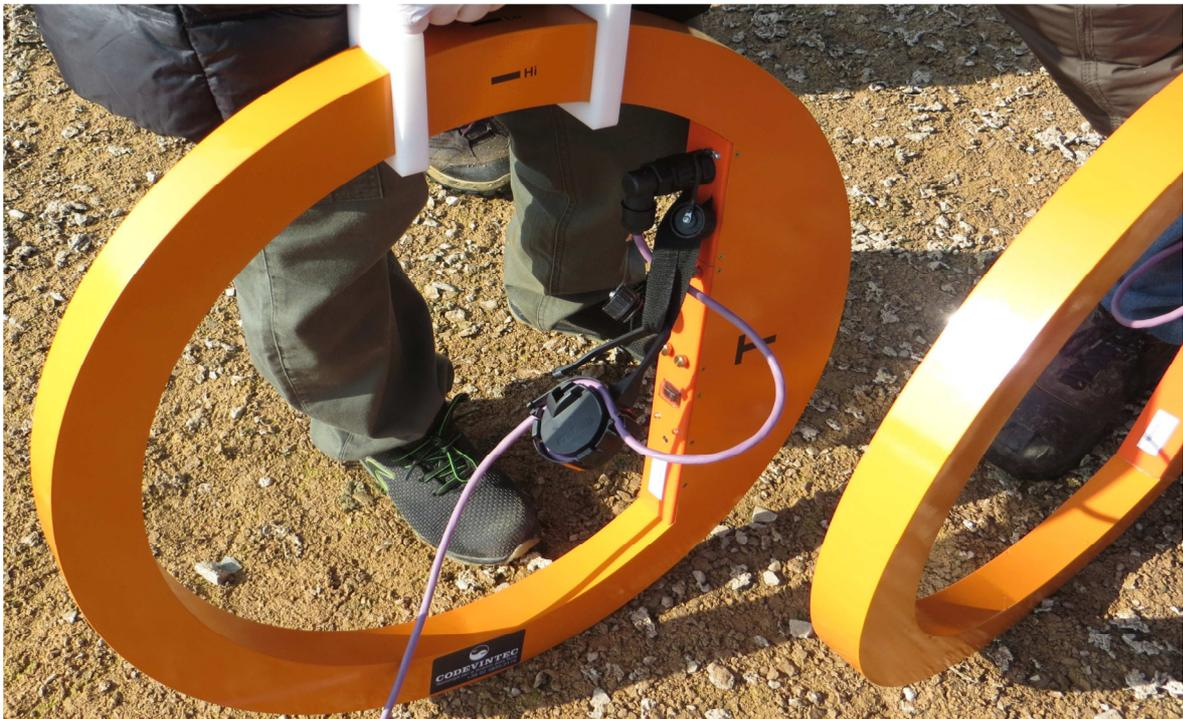
Sonde elettromagnetiche di trasmissione e ricezione utilizzate nell'indagine.
