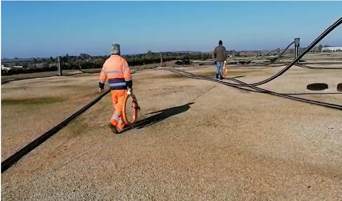
Configurazione Vertical Magnetic Dipole (VMD) con dipoli magnetici distanziati di 10 metri.
