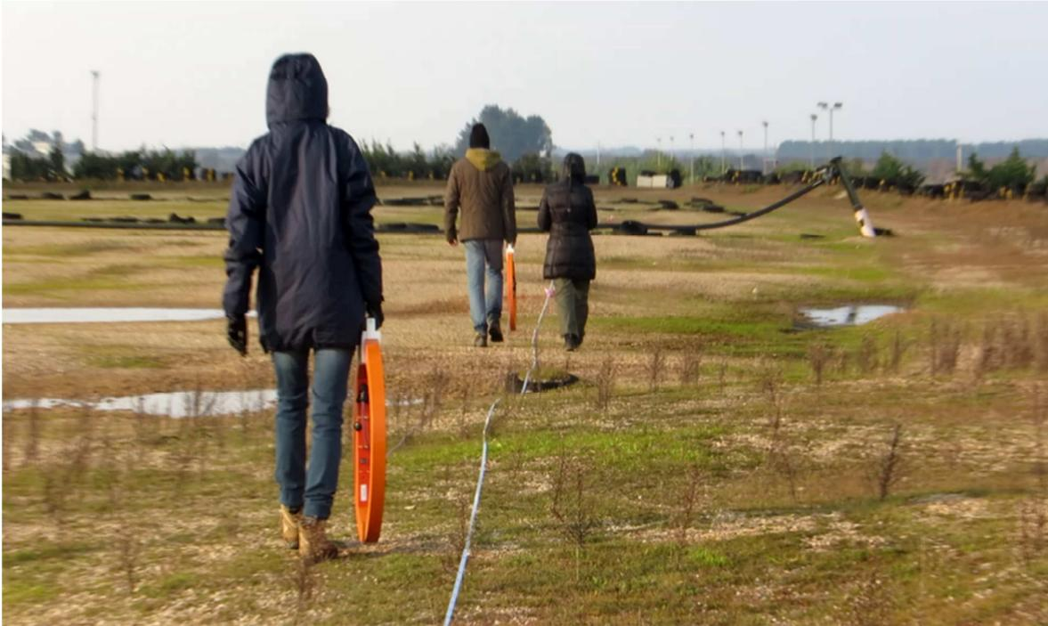
Configurazione Vertical Magnetic Dipole (VMD) con dipoli magnetici distanziati di 40 metri.
