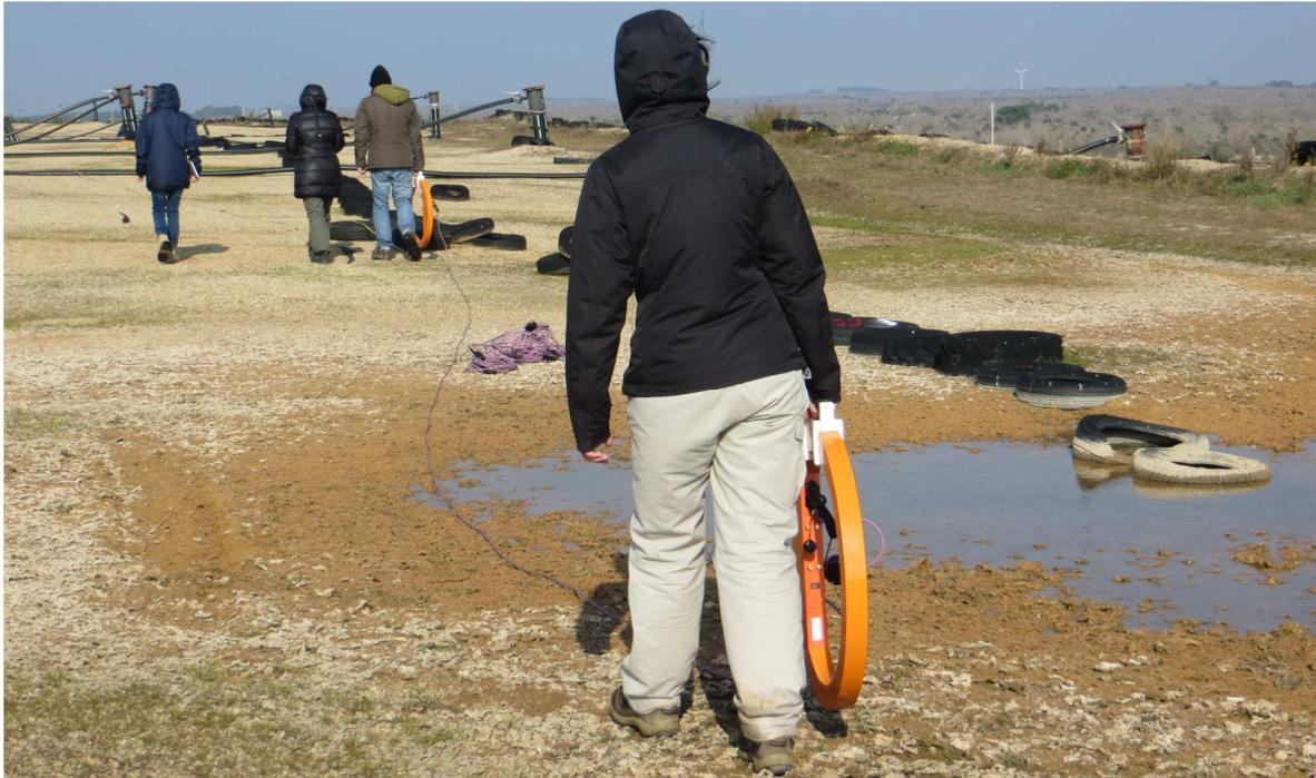
Configurazione Vertical Magnetic Dipole (VMD) con dipoli magnetici distanziati di 20 metri.
