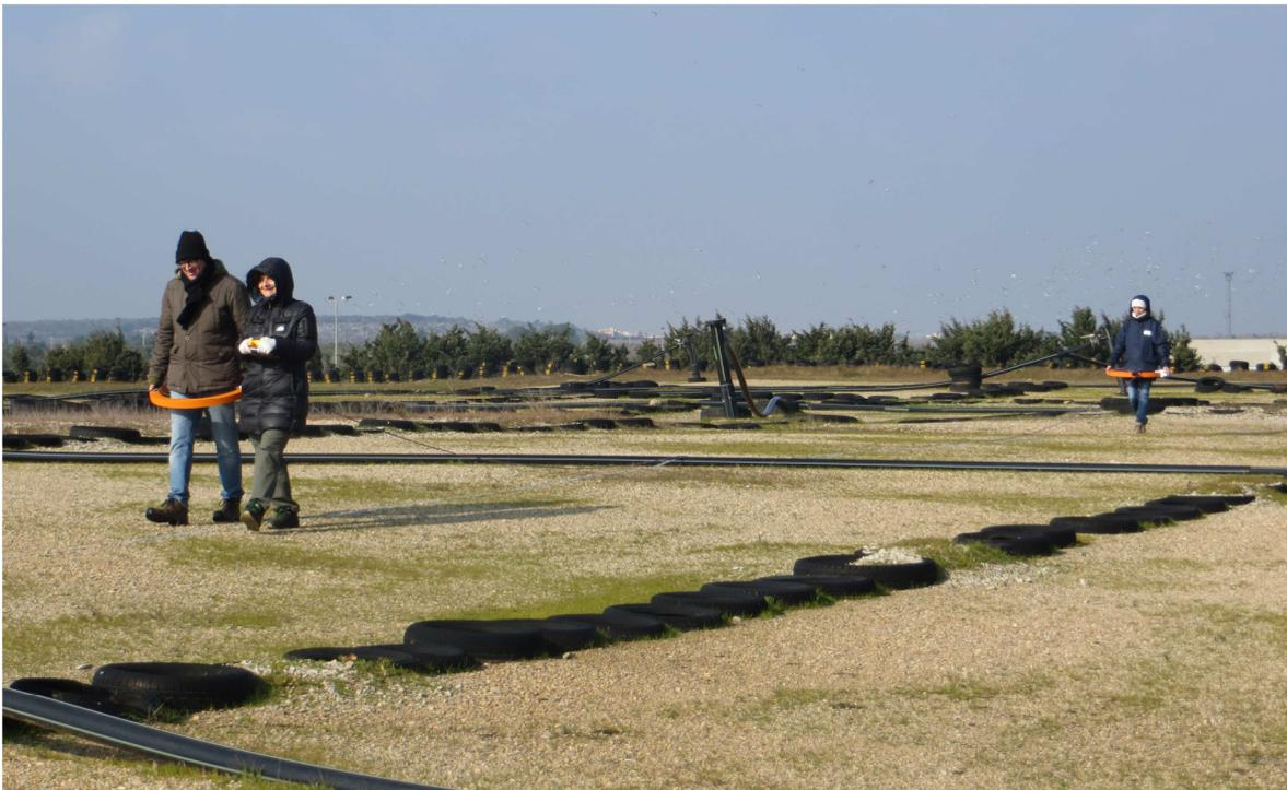
Configurazione Horizontal Magnetic Dipole (HMD) con dipoli magnetici distanziati di 40 metri
