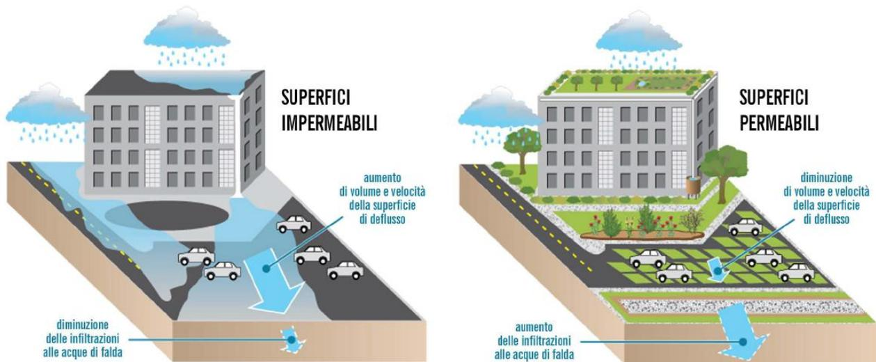
*Invarianza idraulica: gestione delle acque pluviali*
