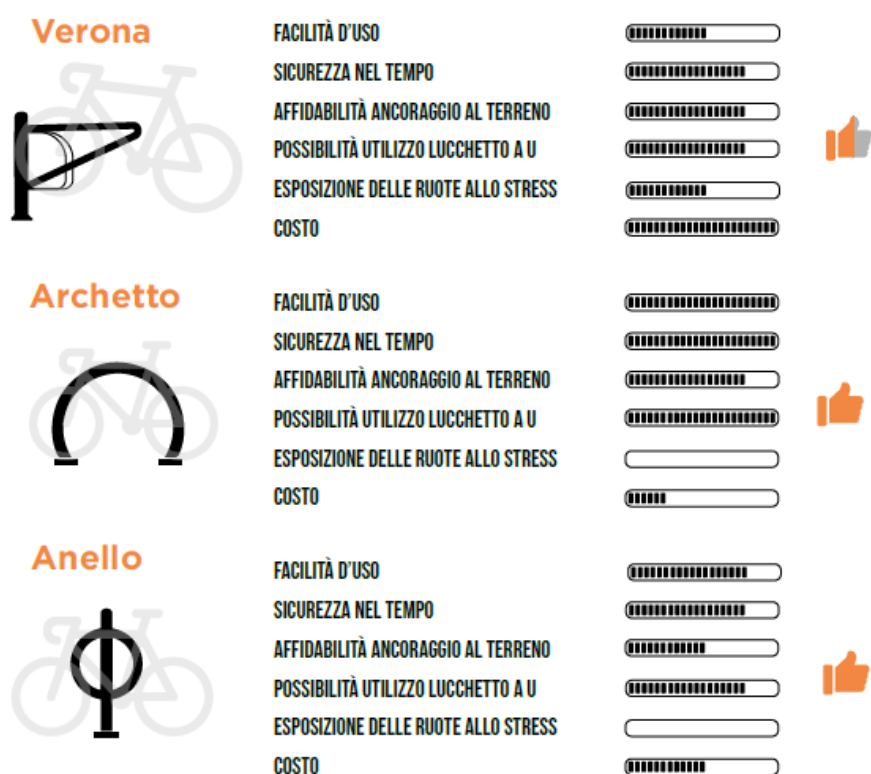
Figura 5-4: Rastrelliere con aggancio della bici all'altezza del telaio
