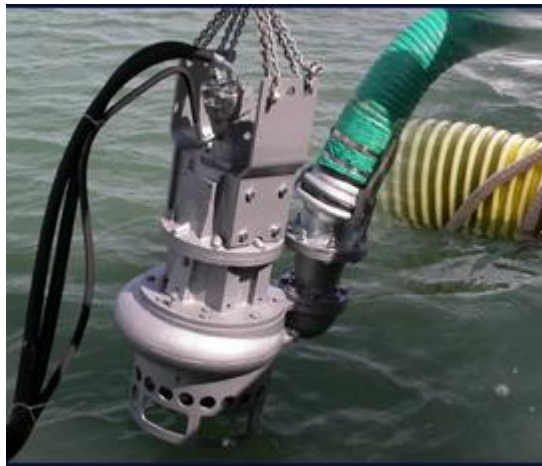
Figura 5.2.1: Vista della pompa idraulica dragante.
