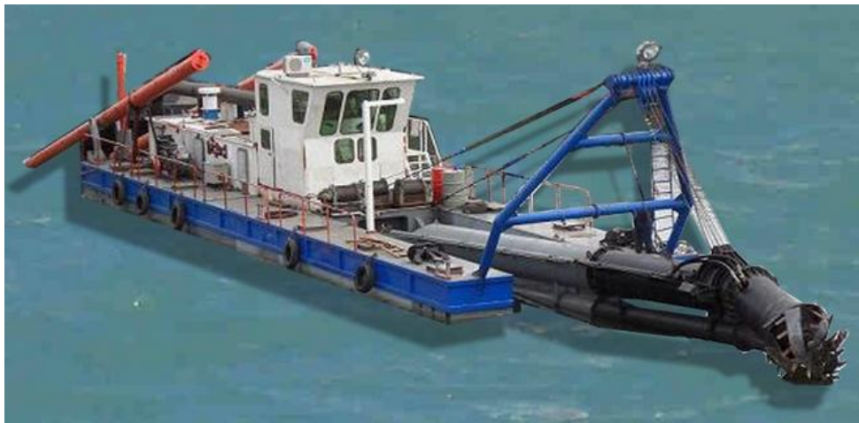
Figura 4.1.2: Vista tipo della draga aspirante stazionaria con disgregatore (CSD).
