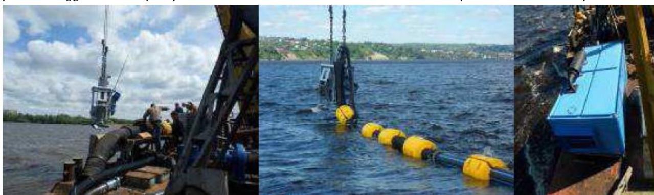
Figura 4.1.4: Esempio di pompa dragante con centralina oleodinamica.
