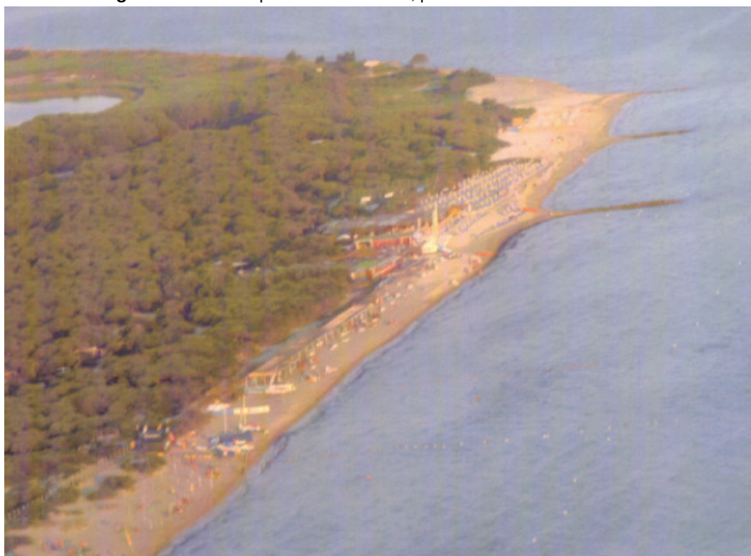
Figura 5. I 3 pennelli realizzati il 2003 in località "le Fontanelle"
