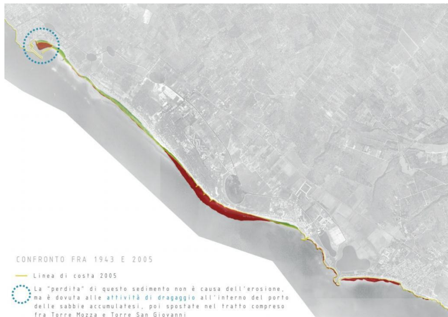
Figura 5 Evoluzione della costa dal 1943 al 2005: in rosso sono segnalate le superfici in arretramento
