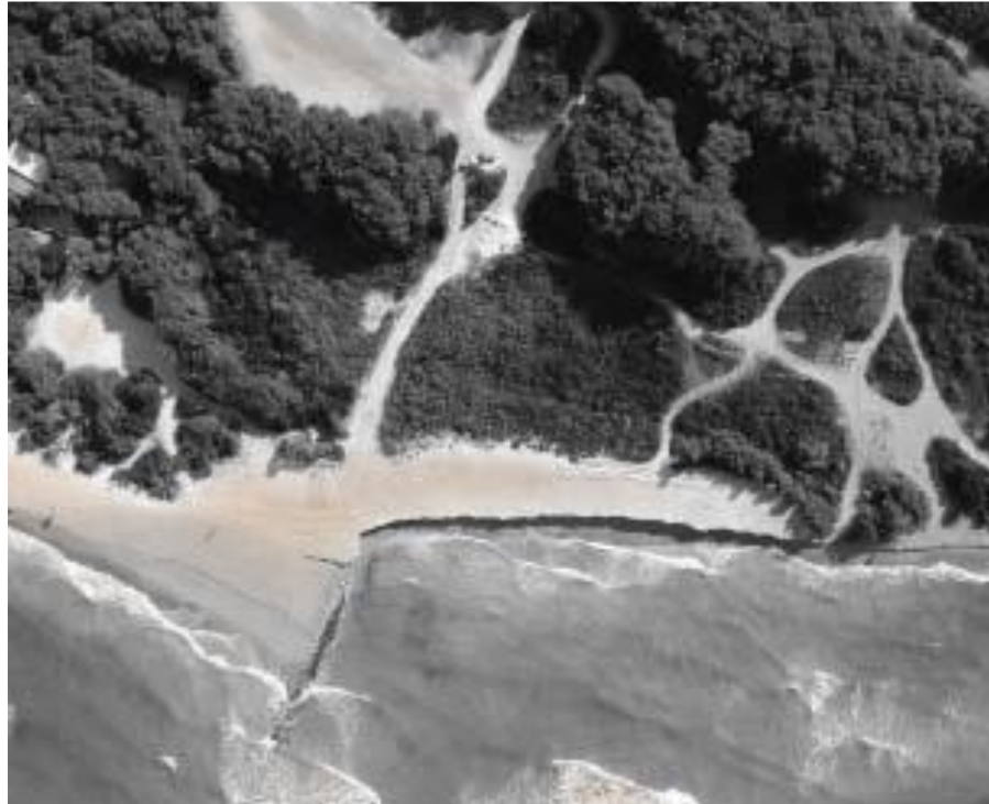
Figura 24 Erosione a sud del pennello in Località Fontanelle
